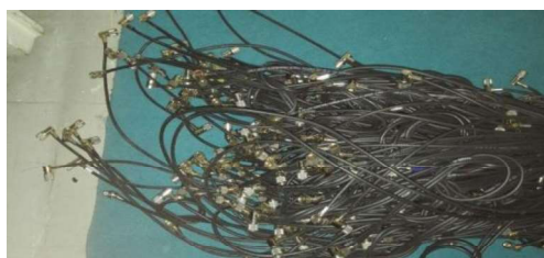
تصویر کابل های کواکسیال و کانکتورهای آن
